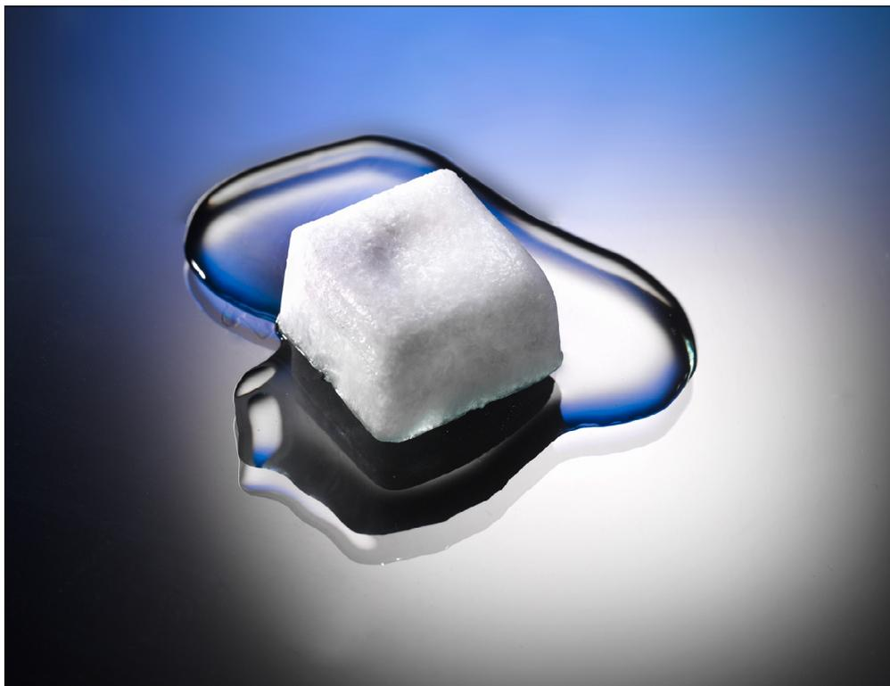
Der PCM-Würfel behält eine Temperatur von 21°C, bis er komplett geschmolzen ist.
